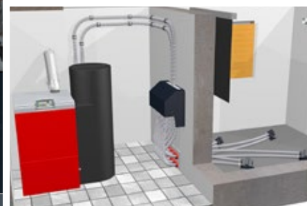
Figure 10. Système pneumatique de livraison de granules de bois. Les granules sont stockés dans une salle (à droite) puis automatiquement acheminés à la chaudière à l'aide de têtes d'aspiration, (sur le plancher, à droite). Ceci permet d'acheminer les granules à partir d'un contenant à fond plat. (Photo : Biothermic)
