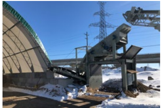
Figure 29. Les copeaux de bois sont déchetés par des déchettesuses à chargement manuel, puis triés par un tamis à agrégats à trois étages afin de retirer les particules fines et grossières, ne laissant que les copeaux d'une taille adéquate pour le système de biothermie. (Photo : Biothermic)
