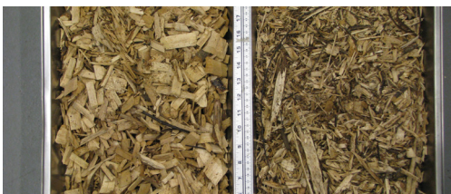
Figure 2. Copeaux de bois de qualité supérieure (à gauche) et de moins bonne qualité (à droite).
